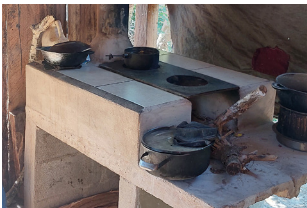
Einer der 35 Brennholz sparenden Herdöfen des Projekts „Rio Grande“ im Süden Nicaraguas.
